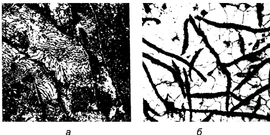
Рис. 4.3. Микроструктуры серых чугунов, \times 300 : а – перлитного; б – ферритного
